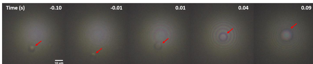
FIGURE 5.5 – Autre exemple de goutte provoquant l'éclatement du film. La goutte entre très tôt dans le film : on observe les premières franges d'interférences qui correspondent à une épaisseur de quelques micromètres. L'épaisseur du film est donc du même ordre de grandeur que celle de la goutte. Le temps de vie du film est très court : moins de 0.1 s.
